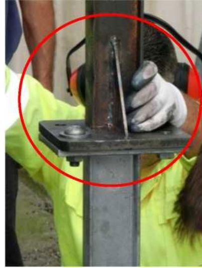
Fig. 9: Verktøy for stolpehamring skrudd fast på stolpen.
