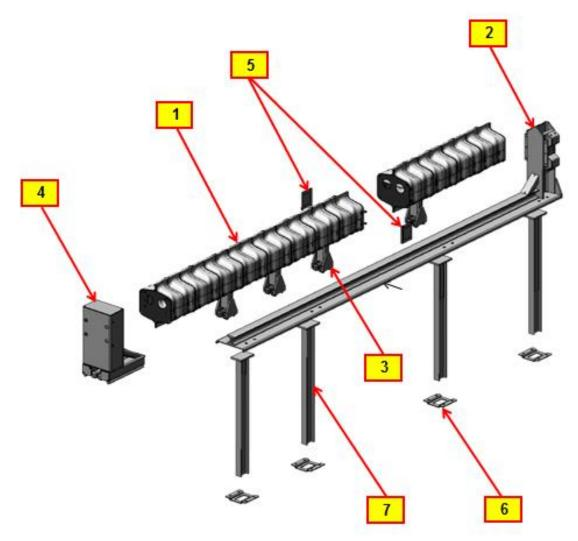
Fig. 1: Componenti del terminale di barriera SMA T2
